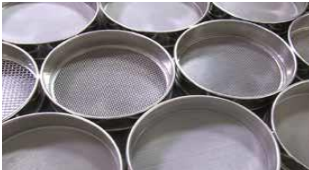
شکل ۳- غربالهایی با اندازه های مختلف جهت جداسازی نمونه دان آردی توسط اندازه ذرات
